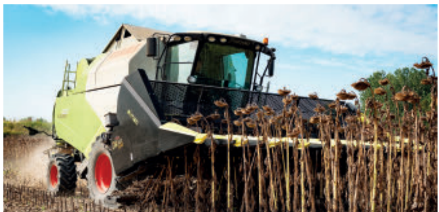
DragoGold, la testata girasole-sorgo-canapa super-performante con trinciastocchi idraulico
